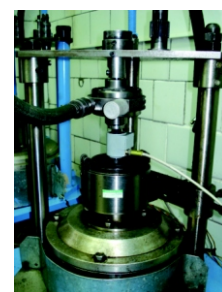
Стенд для испытания пневмодвигателя
