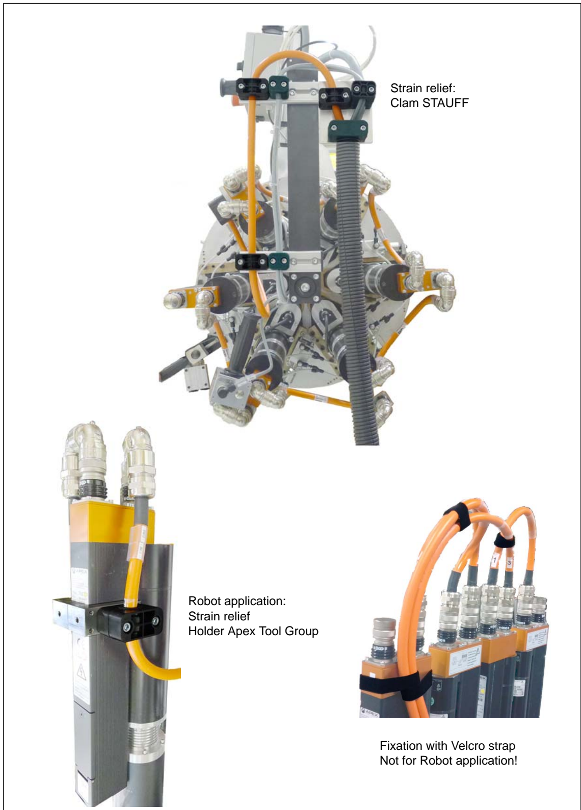
Abb. 6-1: Installationsbeispiele
