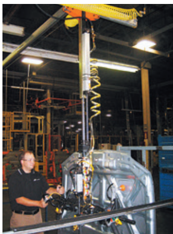
Реактивная стойка, объединенная с вакуумным манипулятором
