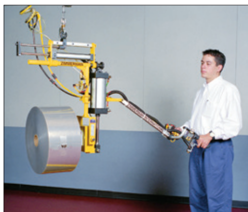
Специализированный манипулятор с механизмом поворота за счет пневмоцилиндра
